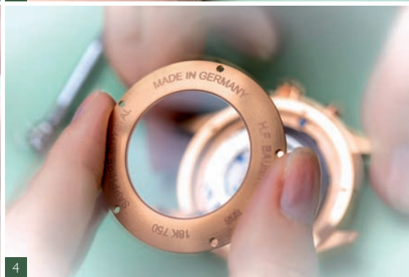
1. Setzen der Krone 2. Montage des Rotors 3. Fixieren des Rotors 4. Der Boden ist mit entspiegeltem Saphirglas ausgestattet
